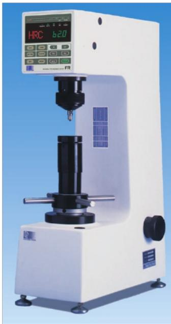
洛氏硬度计按自动化程度分类：手动洛氏硬度计：初始测试力为手动加载；手动加载和卸载主要测试力；操作步骤：压头接触样品，大指针转三圈，手动拉下施力手柄加载，手动按下手柄卸载，看指针读数，分辨率0.5HR；□洛氏硬度计：初始测试力为手动加载；自动主负荷、自动负荷保护、自动卸载（需按“负荷键”；饱和时间可调）；操作步骤：压头接触样品，转动大指针三次，按下“加载键”，自动加载，自动保持加载，自动卸载，指针读数分辨率为0.1HR；北京淬火与回火调质硬度洛氏硬度计报价洛氏硬度测量是在洛氏硬度计上进行的。
