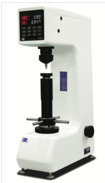
洛氏硬度计使用方法：1、使用前应首先检查硬度计是否放置水平，稳固。如不稳固应在水平的基础上将硬度计垫至稳固状态。水平：较好的方法就是看硬度计后盖里的挂砣应与托架不碰不靠（左右和里面，外边应不碰外壁）。2、开电源开关，指示灯应亮起来，如不亮，应找电工检查是否有市电到电源插座。如有市电，应检查保险丝是否正常。如正常检查灯泡和灯泡电路及变压器。3、用标准硬度块进行一次使用前比对，检查硬度计是否正常，如不正常，应停止使用，请专业人员调试。4、比对正常后，应对样块进行处理，圆形或三角形应选用V型台面，其他形状，应选用两个平行面（较好平行，可以的话进行一定的修磨），因为不平行将会影响测量的准确度和损坏合金钢硬度头。
